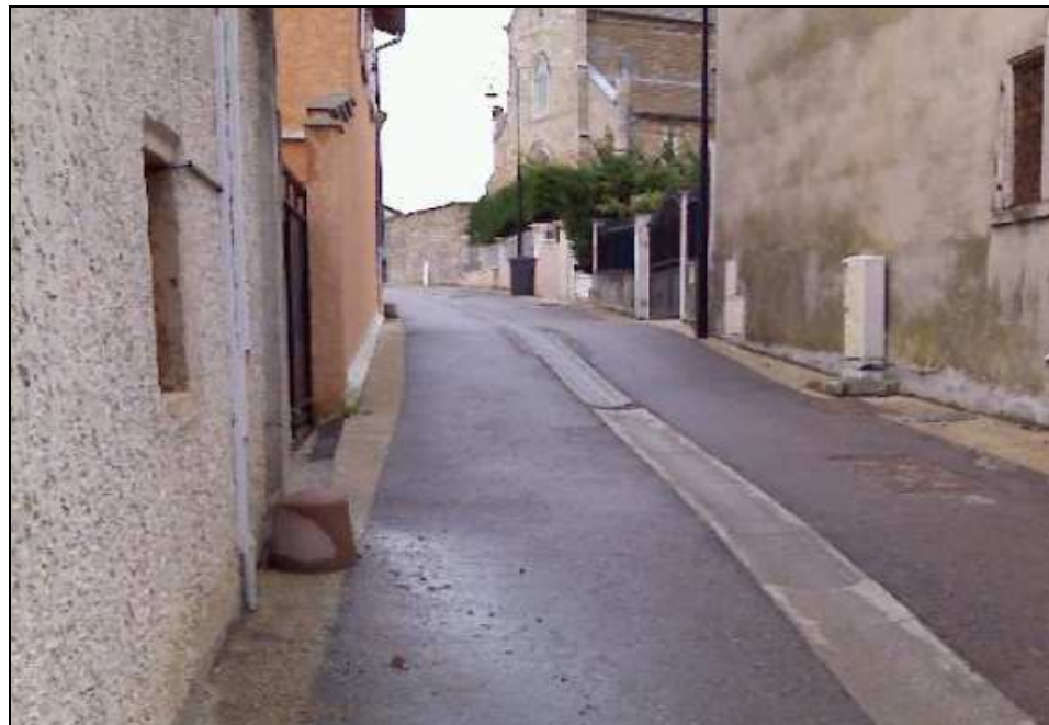
Colombier-Saugnieu – Rue de l'Église : Impossibilité d'élargir un trottoir sans remettre en cause le double-sens de circulation automobile : création d'une Zone de Rencontre pour permettre la circulation piétonne sur la chaussée.
